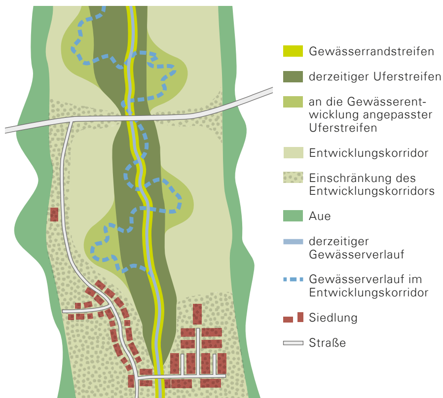
Abb. 5: Schemabild Gewässerrandstreifen-Uferstreifen-Entwicklungskorridor (STMUV 2022)
